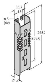
Montagehalterung, für PVD225, kaltgewalzter Stahl, keine Aussparung für DIP-Schalter-Bank
