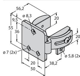
Montagewinkel, schwarz, Stahl, für EZ-ARRAY und EZ-SCREEN Standard und Kaskade 14 & 30 mm
