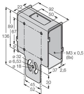
Schutzgehäuse mit Schutzglas,
