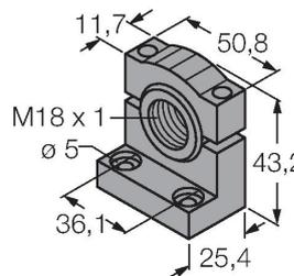
Montagehalterung, PBT-schwarz, für Sensoren mit 18-mm-Gewinde, ausrichtbar
