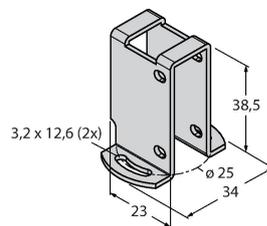
Schutzgehäuse, Edelstahl, für Bauform Q20
