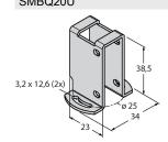
Schutzgehäuse, Edelstahl, für Bauform Q20
