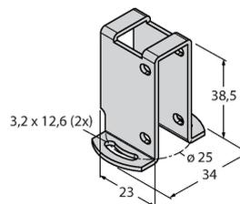
Schutzgehäuse, Edelstahl, für Bauform Q20
