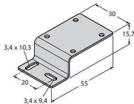
Montagewinkel, Edelstahl, horizontale Montage, für Bauform Q20
