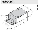
3079041 Montagewinkel, Edelstahl, horizontale Montage, für Bauform Q20
