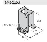
Schutzgehäuse, Edelstahl, für Bauform Q20
