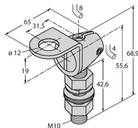
Montagewinkel, Edelstahl, für Bauform M12, Gewinde M10 x 1,5
