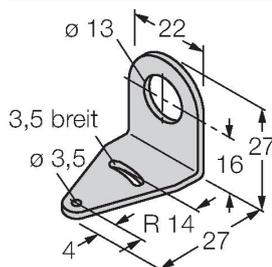
Montagewinkel, Werkstoff VA 1.4401, für Bauform QS12 & M12
