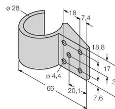
Montagehalterung, für PVA und PVD, zur Montage auf 28 mm Rohren, 4 Halterungen im Lieferumfang enthalten (2 pro Sensor)
