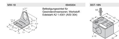
Befestigungsschelle für Gewinderohrsensoren, ohne Festanschlag; Werkstoff: PA6
