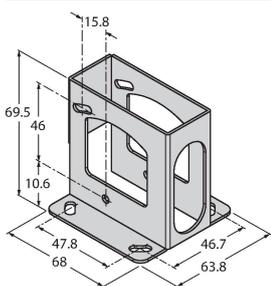
Schutzgehäuse, Edelstahl, für Sensoren der Baureihe LE250/550
