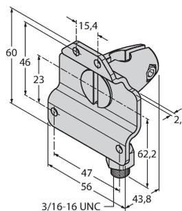
Haltewinkel, drehbar, Edelstahl, für Sensoren der Baureihe LE250/550
