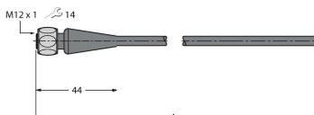
Anschlussleitung, M12-Kupplung, gerade, 5-polig, Edelstahlüberwurfmutter, Leitungslänge: 2 m, Mantelmaterial: TPE, grau; Temperaturbereich: -40...+105 °C
