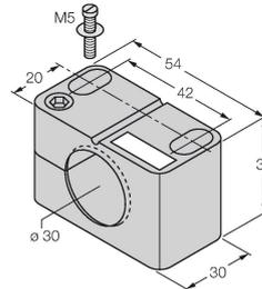
Befestigungsschelle für Gewinderohrsensoren, mit Festanschlag; Werkstoff: PA6
