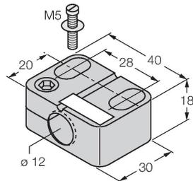
Befestigungsschelle für Gewinderohrsensoren, mit Festanschlag; Werkstoff: PA6
