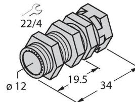
Schnellmontagehalterung mit Festanschlag; Werkstoff: Messing PTFE-beschichtet. Außengewinde M16 x 1. Hinweis: Der Schaltabstand der Näherungsschalter kann sich durch Verwendung von Schnellmontagehalterungen ändern.
