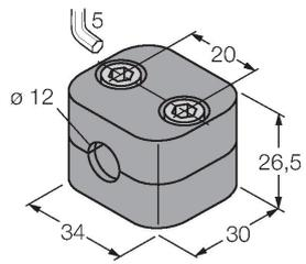
Befestigungsschelle für Glatt- und Gewinderohrsensoren; Werkstoff: Polypropylen
