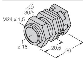
Schnellmontagehalterung mit Festanschlag; Werkstoff: Messing PTFE-beschichtet. Außengewinde M24 x 1,5. Hinweis: Der Schaltabstand der Näherungsschalter kann sich durch Verwendung von Schnellmontagehalterungen ändern.
