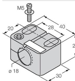
Befestigungsschelle für Gewinderohrsensoren, mit Festanschlag; Werkstoff: PA6
