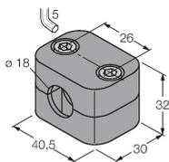
Befestigungsschelle für Glatt- und Gewinderohrsensoren; Werkstoff: Polypropylen
