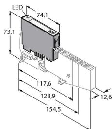
4 digitale Eingänge gemäß EN 60947-5-6. Für NAMUR-Sensoren, spannungsfreie Kontakte oder uprox+ Zweidraht DC Sensoren.
