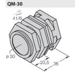
Schnellmontagehalterung mit Festanschlag; Werkstoff: Messing verchromt. Außengewinde M36 x 1,5. Hinweis: Der Schaltabstand der Näherungsschalter kann sich durch Verwendung von Schnellmontagehalterungen ändern.
