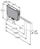
4 digitale Eingänge gemäß EN 60947-5-6. Für NAMUR-Sensoren, spannungsfreie Kontakte oder uprox+ Zweidraht DC Sensoren.
