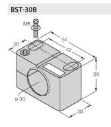
Befestigungsschelle für Gewinderohrsensoren, mit Festanschlag; Werkstoff: PA6
