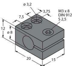
Befestigungsschelle für Gewinderohrsensoren; Werkstoff Montageblock: Aluminium, eloxiert
