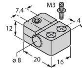
Befestigungsschelle für Gewinderohrsensoren, mit Festanschlag; Werkstoff: PA6
