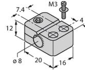
Befestigungsschelle für Gewinderohrsensoren, mit Festanschlag; Werkstoff: PA6
