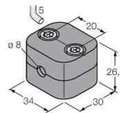
Befestigungsschelle für Glatt- und Gewinderohrsensoren; Werkstoff: Polypropylen
