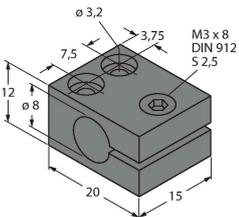
Befestigungsschelle für Gewinderohrsensoren; Werkstoff Montageblock: Aluminium, eloxiert
