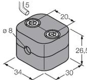
Befestigungsschelle für Glatt- und Gewinderohrsensoren; Werkstoff: Polypropylen
