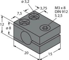
Befestigungsschelle für Gewinderohrsensoren; Werkstoff Montageblock: Aluminium, eloxiert
