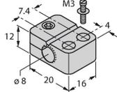
Befestigungsschelle für Gewinderohrsensoren, mit Festanschlag; Werkstoff: PA6
