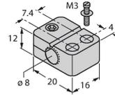
Befestigungsschelle für Gewinderohrsensoren, mit Festanschlag; Werkstoff: PA6
