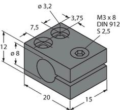
Befestigungsschelle für Gewinderohrsensoren; Werkstoff Montageblock: Aluminium, eloxiert
