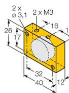
Betätigungsmagnet; Quader Kunststoff; erreichbarer Schaltabstand 58 mm auf Magnetfeldsensoren BIM-(E)M12 bzw. 49 mm auf BIM-EG08; bei Linearwegsensoren Q25L: empfohlene Entfernung zwischen Sensor und Magnet: 3...5 mm
