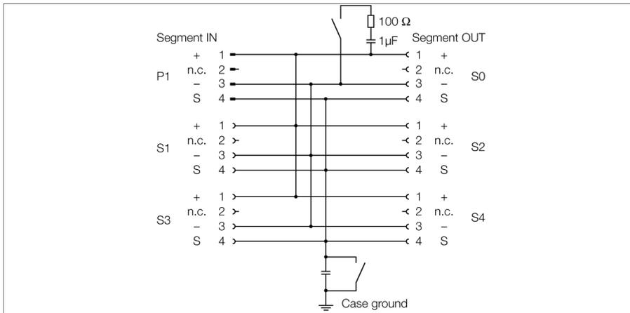
Der vierkanalige Ex-Verteilerbaustein vom Typ JBBS-48-E413/EX ist für den PROFIBUS-PA ausgelegt.
