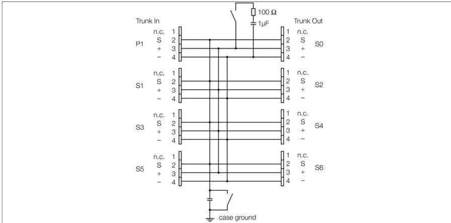
Der sechskanalige Ex-Verteilerbaustein vom Typ JBBS-48-T615B/EX ist für den PROFIBUS-PA ausgelegt.
