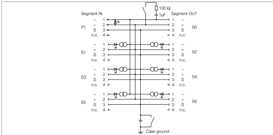
Der sechskanalige Verteilerbaustein vom Typ JBBS-49SC-E613/3G ist für den FOUNDATION™ fieldbus ausgelegt.
