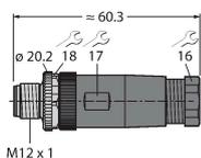
Konfektionierbarer Stecker, M12 x 1, gerade, 12-polig, Lötkontakt, Leitungsdurchlass 6.0 bis 8.0 mm, Adernquerschnitt/ Klemmvermögen 0.14 bis 0.25 mm<sup>2</sup>, Kunststoffgehäuse, Metallüberwurfschraube
