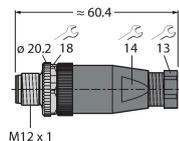
Konfektionierbarer Stecker, M12 x 1, gerade, 4-polig, Schraubklemmanschluss, Leitungsdurchlass 4.0 bis 6.0 mm, Adernquerschnitt/ Klemmvermögen 0.14 bis 0.75 mm<sup>2</sup>, Kunststoffgehäuse, Metallüberwurfschraube
