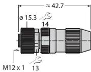
Konfektionierbare Kupplung, M12 x 1, gerade, 4-polig, Schneidklemmanschluss, Leitungsdurchlass 4.0 bis 5.1 mm, Adernquerschnitt/ Klemmvermögen 0.14 bis 0.34 mm<sup>2</sup>, Kunststoffgehäuse, Metallüberwurfmutter
