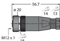
Konfektionierbare Kupplung, M12 x 1, gerade, 4-polig, Schraubklemmanschluss, Leitungsdurchlass 4.0 bis 6.0 mm, Adernquerschnitt/ Klemmvermögen 0.25 bis 0.75 mm<sup>2</sup>, Kunststoffgehäuse, Metallüberwurfmutter
