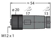
Konfektionierbare Kupplung, M12 x 1, gerade, 5-polig, Schraubklemmanschluss, Leitungsdurchlass 4.0 bis 6.0 mm, Adernquerschnitt/ Klemmvermögen 0.14 bis 0.75 mm<sup>2</sup>, Kunststoffgehäuse, Kunststoffüberwurfmutter
