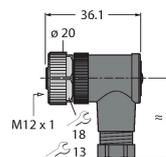
Konfektionierbare Kupplung, M12 x 1, gewinkelt, 5-polig, Schraubklemmanschluss, Leitungsdurchlass 4.0 bis 6.0 mm, Adernquerschnitt/ Klemmvermögen 0.25 bis 0.75 mm<sup>2</sup>, Kunststoffgehäuse, Metallüberwurfmutter
