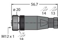
Konfektionierbare Kupplung, M12 x 1, gerade, 5-polig, Schraubklemmanschluss, Leitungsdurchlass 4.0 bis 6.0 mm, Adernquerschnitt/ Klemmvermögen 0.25 bis 0.75 mm<sup>2</sup>, Kunststoffgehäuse, Metallüberwurfmutter
