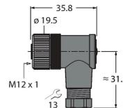
Konfektionierbare Kupplung, M12 x 1, gewinkelt, 5-polig, Schraubklemmanschluss, Leitungsdurchlass 4.0 bis 6.0 mm, Adernquerschnitt/ Klemmvermögen 0.14 bis 0.75 mm<sup>2</sup>, Kunststoffgehäuse, Kunststoffüberwurfmutter
