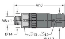
Konfektionierbarer Stecker, M8 x 1, gerade, 4-polig, Schraubklemmanschluss, Leitungsdurchlass 4.0 bis 5.5 mm, Adernquerschnitt/ Klemmvermögen 0.14 bis 0.5 mm<sup>2</sup>, Kunststoffgehäuse, Metallüberwurfschraube
