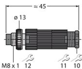
Konfektionierbarer Stecker, M8 x 1, gerade, 4-polig, Eindringtechnik, Leitungsdurchlass 4.0 bis 5.0 mm, Adernquerschnitt/ Klemmvermögen 0.14 bis 0.34 mm<sup>2</sup>, Kunststoffgehäuse, Metallüberwurfmutter
