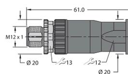
Konfektionierbarer Stecker, M12 x 1, gerade, 5-polig, Schraubklemmanschluss, Leitungsdurchlass 4.0 bis 8.0 mm, Adernquerschnitt/Klemmvermögen 0.25 bis 1.5 mm<sup>2</sup>, Kunststoffgehäuse, Metallüberwurfschraube
