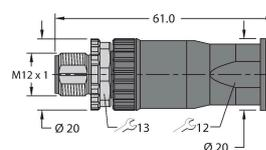
Konfektionierbarer Stecker, M12 x 1, gerade, 4-polig, Schraubklemmanschluss, Leitungsdurchlass 4.0 bis 8.0 mm, Adernquerschnitt/ Klemmvermögen 0.25 bis 1.5 mm<sup>2</sup>, Kunststoffgehäuse, Metallüberwurfschraube
