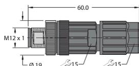
Konfektionierbarer Stecker, M12 x 1, gerade, 4-polig, Push-In-Anschluss, Leitungsdurchlass 4.0 bis 8.0 mm, Adernquerschnitt/ Klemmvermögen 0.14 bis 0.75 mm<sup>2</sup>, Kunststoffgehäuse, Metallüberwurfschraube
