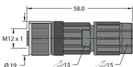
Konfektionierbare Kupplung, M12 x 1, gerade, 4-polig, Push-In-Anschluss, Leitungsdurchlass 4.0 bis 8.0 mm, Adernquerschnitt/Klemmvermögen 0.14 bis 0.75 mm<sup>2</sup>, Kunststoffgehäuse, Metallüberwurfmutter
