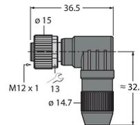
Konfektionierbare Kupplung, M12 x 1, gewinkelt, 4-polig, Schneidklemmanschluss, Leitungsdurchlass 4.0 bis 5.1 mm, Adernquerschnitt/Klemmvermögen 0.14 bis 0.34 mm<sup>2</sup>, Kunststoffgehäuse, Metallüberwurfmutter
