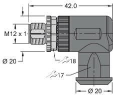
Konfektionierbarer Stecker, M12 x 1, gewinkelt, 5-polig, Schraubklemmanschluss, Leitungsdurchlass 4.0 bis 8.0 mm, Adernquerschnitt/Klemmvermögen 0.25 bis 1.5 mm<sup>2</sup>, Kunststoffgehäuse, Metallüberwurfschraube
