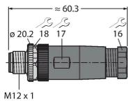
Konfektionierbarer Stecker, M12 x 1, gerade, 12-polig, Lötkontakt, Leitungsdurchlass 6.0 bis 8.0 mm, Adernquerschnitt/ Klemmvermögen 0.14 bis 0.25 mm<sup>2</sup>, Kunststoffgehäuse, Metallüberwurfschraube
