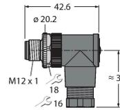
Konfektionierbarer Stecker, M12 x 1, gewinkelt, 12-polig, Lötkontakt, Leitungsdurchlass 6.0 bis 8.0 mm, Adernquerschnitt/ Klemmvermögen 0.14 bis 0.25 mm<sup>2</sup>, Kunststoffgehäuse, Metallüberwurfschraube
