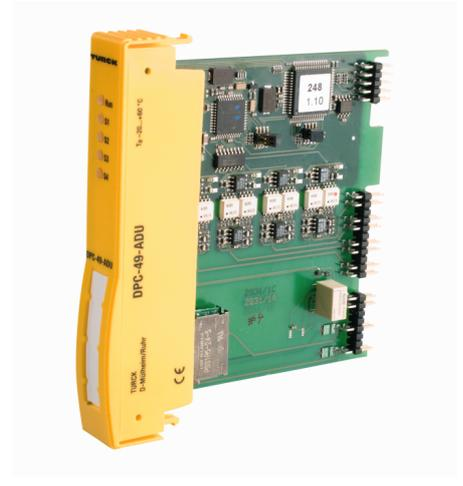
Das DPC-System (Diagnostic-Power-Conditioner-System) ist ein Stromversorgungssystem zum Aufbau von FOUNDATION™ fieldbus H1-Segmenten. Es bietet umfassende Diagnosemöglichkeiten zur Überwachung von FOUNDATION™ fieldbus-Segmenten und unterstützt damit anlagenweites Asset-Management.
