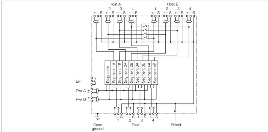
Das DPC-System (Diagnostic-Power-Conditioner-System) ist ein Stromversorgungssystem zum Aufbau von FOUNDATION™ fieldbus H1-Segmenten. Es bietet umfassende Diagnosemöglichkeiten zur Überwachung von FOUNDATION™ fieldbus-Segmenten und unterstützt damit anlagenweites Asset-Management.
