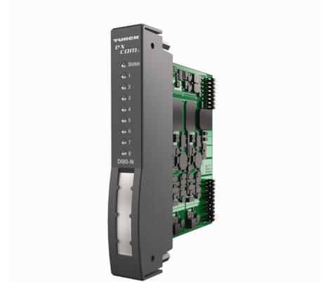
Das digitale Eingangsmodul DI80-N dient zum Anschluss von acht 3-Draht-PNP/NPN-Sensoren (IEC 61131, Type 3). Die Sensorik wird nicht über das Modul gespeist, sondern verpolgeschützt über eine Hilfsenergie, die getrennt für die Kanäle 1...4 (Gruppe 1) und 5...8 (Gruppe 2) extern über die Anschlussklemmen zugeführt wird. Die Eingangsgruppen sind galvanisch von einander getrennt.
