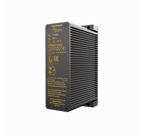
Der AC/DC-Umsetzer PPSA115Ex dient der Versorgung des excom®-Systems bis zum Vollausbau. Der Umsetzer ist in einer kombinierten Schutzart Ex m und Ex e ausgeführt und kann daher in Zone 1 eingesetzt werden. Es ist vollvergossen in einem Aluminium-Schutzgehäuse eingebaut.
