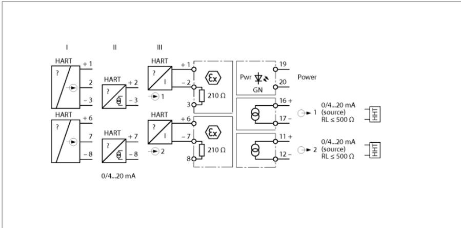
Über den 2-kanaligen HART®-Messumformer-Speisetrenner IM33-22EX-HI werden eigensichere HART®-2-Draht-Messumformer (III) im Ex-Bereich betrieben und die Messsignale in den Nicht-Ex-Bereich übertragen. Neben den Analogsignalen können bidirektional auch die digitalen Signale der HART®-Kommunikation übertragen werden.
