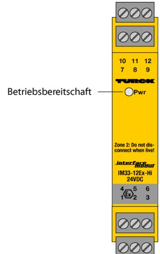
Über den 1-kanaligen HART®-Messumformer-Speisetrenner IM33-12Ex-HI/24VDC werden eigensichere HART®-2-Draht-Messumformer (III) im Ex-Bereich betrieben und das Messsignal in den Nicht-Ex-Bereich übertragen. Neben den Analogsignalen können bidirektional auch die digitalen Signale der HART®-Kommunikation übertragen werden.
