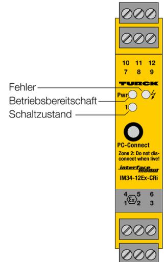
Mit dem 1-kanaligen Ex-Temperatur-Messverstärker des Typs IM34-12EX-CRI werden die temperaturabhängigen Änderungen von Ni100/Pt100-Widerständen, Thermoelementen der Typen B, E, J, K, L, N, R, S und T oder Kleinspannungen im Bereich von -160...+160 mV ausgewertet und als Stromsignale von 0/4...20 mA temperaturlinear ausgegeben.
