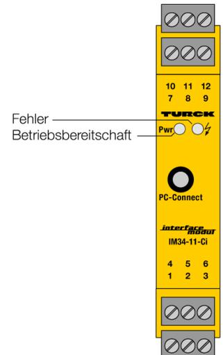
Mit dem 1-kanaligen Temperatur-Messverstärker des Typs IM34-11-CI werden die temperaturabhängigen Änderungen von Ni100/Pt100-Widerständen, Thermoelementen der Typen B, E, J, K, L, N, R, S und T oder Kleinspannungen im Bereich von -160...+160 mV ausgewertet und als Stromsignale temperaturlinear ausgegeben.
