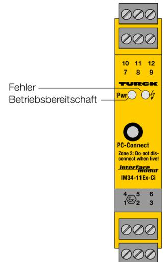
Mit dem Temperatur-Messverstärker des Typs IM34-11EX-CI/K70 werden die temperaturabhängigen Änderungen von Ni100/Pt100-Widerständen, Thermoelementen der Typen B, E, J, K, L, N, R, S und T oder Kleinspannungen im Bereich von -160...+160 mV ausgewertet und als Stromsignale von temperaturlinear ausgegeben.
