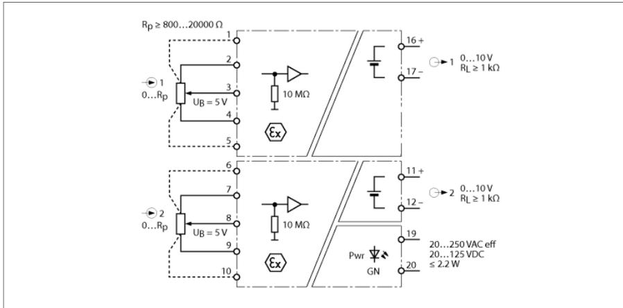
Über den 2-kanaligen Potentiometerverstärker IM36-22EX-U werden Signale von Potenziometern in 3/5-Leiter-Schaltung galvanisch getrennt aus dem Ex-Bereich in den Nicht-Ex-Bereich übertragen und in normierte Analogsignale von 0...10 V umgewandelt. Der Widerstandswert des Schleiferabgriffes wird von 0 Ω bis zum Nennwiderstandswert (Endwert) des Potenziometers erfasst und linear verarbeitet.
