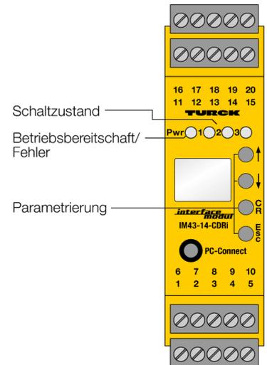
Über den 1-kanaligen Messumformer-Speisetrenner IM43-14-CDRI werden 2-Draht-Messumformer (III) betrieben und die Messsignale galvanisch getrennt übertragen. Darüber hinaus können alternativ passive 2-Draht-Transmitter (II) und aktive 3-Draht-Transmitter (I) betrieben werden.
