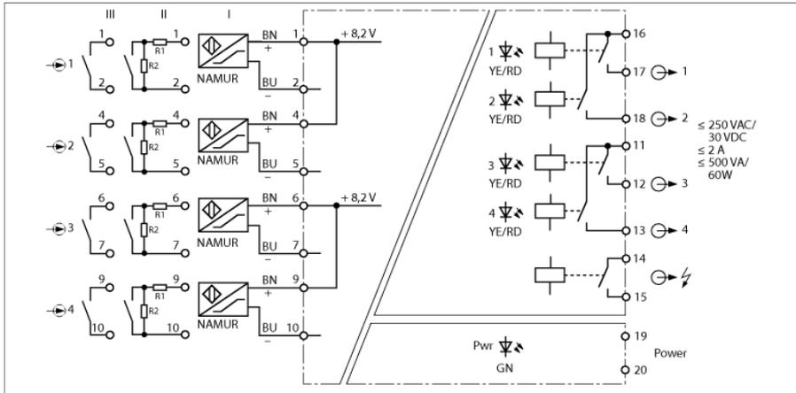
An den 4-kanaligen Trennschaltverstärker vom Typ IM1-451-R können Sensoren nach EN 60947-5-6 (NAMUR) oder potenzialfreie Kontaktgeber angeschlossen werden.
