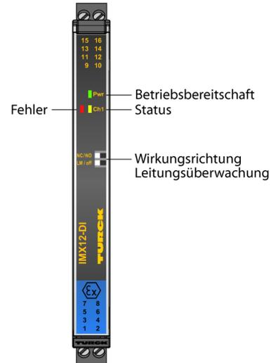
An den NAMUR-Repeater IMX12-DI03-1S-1NAM1R-PR/24VDC können Sensoren nach EN 60947-5-6 (NAMUR) oder potenzialfreie Kontakte angeschlossen werden. Das Gerät ist mit einem eigensicheren Eingangskreis ausgestattet und kann in Zone 2 montiert werden. Der Ausgangskreis ist zusätzlich mit 1 Relaisausgang ausgestattet. Das Gerät kann über eine Power-Bridge versorgt werden, die auch eine Sammelstörmeldung überträgt. Das Gerät erfüllt die Anforderungen der NE21.
